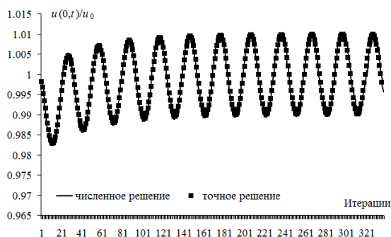
Рис. 3 – Скорость на входе в канал по итерациям
