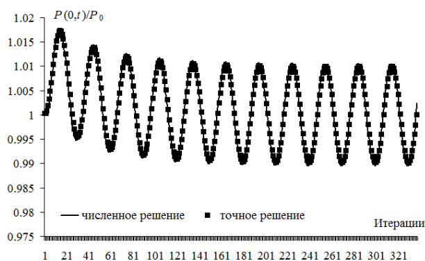
Рис. 2 – Давление на входе в канал по итерациям
