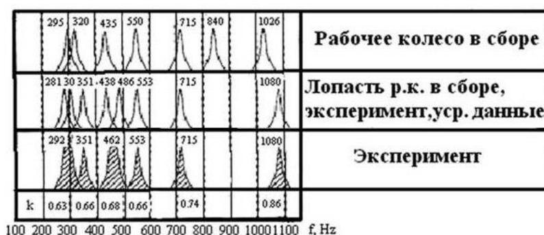
Рис. 5 – Схема спектрограмм собственных частот элементов рабочего колеса ПЛ-60/1075 в воде.
