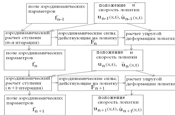
Рис.5 – Блок-схема расчета n -ой итерации аэроупругой модели
