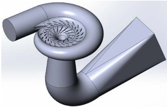
Рис. 1. Твердотільна модель проточної частини гідротурбіни РО 310
