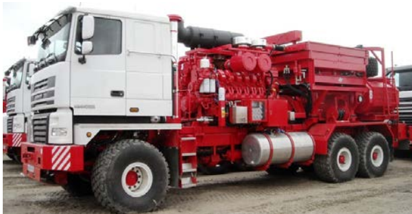
Рис. 1. Насосний агрегат FC-2251 виробництва «Стюарт і Стівенсон» (США)
