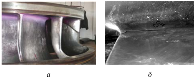
Рис. 1. Приклади типових пошкоджень та дефектів елементів гідротурбін: а – тріщина на лопаті [2]; б – тріщина на лопаті [3]
