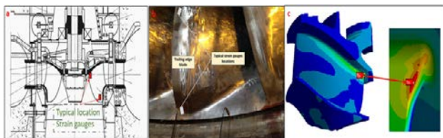
Рис. 8. Розташування тензодатчиків у гарячих точках hot spot [15]
