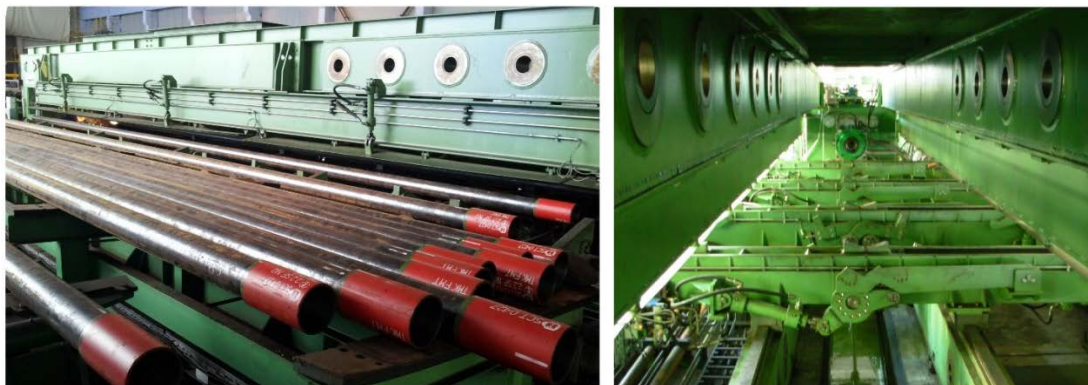
Рис. 1. Загальний вигляд гідропреса для гідростатичного випробування труб
