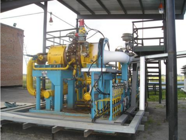
Рис. 4. Турбодетандер виробництва ПрАТ «Гурбогаз» (м. Харків)
