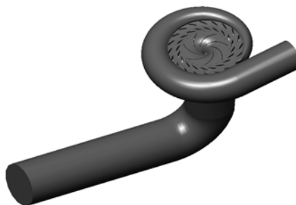
Рис. 2. Твердотельная модель проточной части насос-турбины
