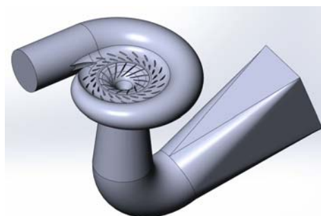
Рис. 3. Твердотельная модель радиально-осевой гидротурбины
